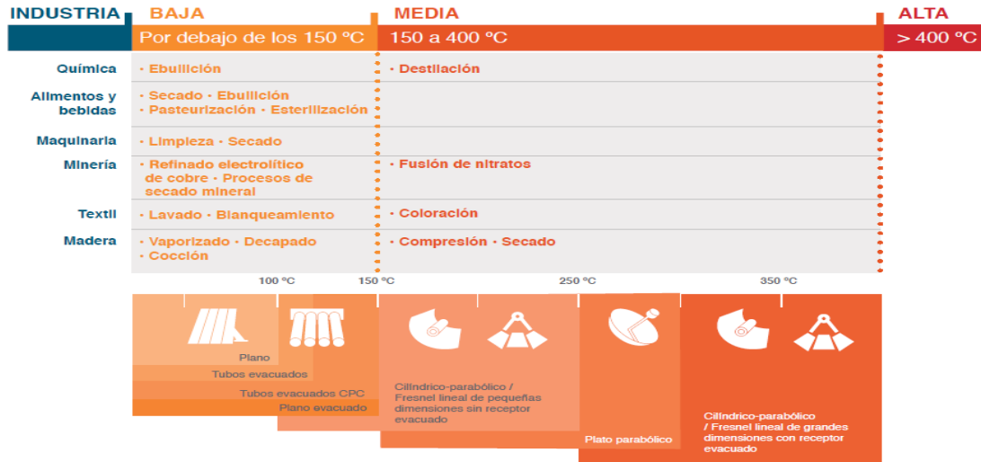
Ilustración 1.1. Rangos de temperatura, aplicaciones y tecnología solar. Calor solar para la industria en México. Fuente: Solar Payback, 2018
