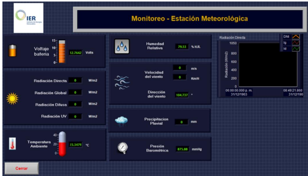
Ilustración 4.5 Panel frontal – interfaz de la Estación Solarimétrica y meteorológica. Fuente: Estación meteorológica del IER, UNAM
