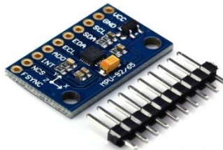
Ilustración 3.5 Acelerómetro MPU9250. Fuente: Mercado libre
