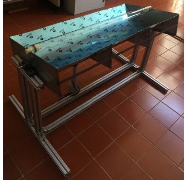
Ilustración 2.31 Estructura base para soporte del concentrador solar. En esta fotografía el tubo absorbedor aún no tiene colocado el tubo de cobre. Fuente: elaboración propia
