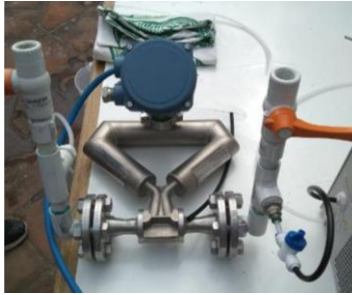
Ilustración 4.2 Medidor de flujo de efecto Coriolis.
