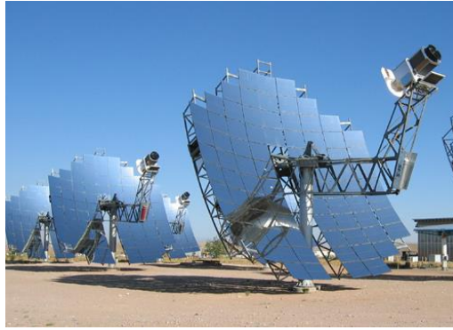
Ilustración 2.20 Disco Stirling. Fuente: Stirling Energy Systems, Fotografía por Randy J. Montoya (2008)
