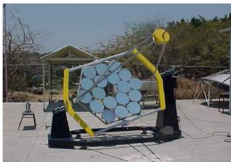
**Figura 24.** Dispositivo para el Estudio de Flujos Radiativos Altamente Concentrados (DEFAC) Del Instituto de Energías Renovables de la UNAM (IER-UNAM, 2005).
