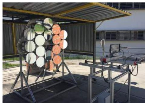
**Figura 25.** Horno solar a escala del Instituto de Energías Renovables de la UNAM.
