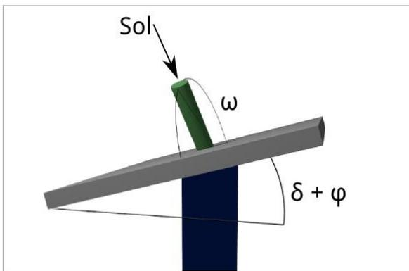
Figura 3.13 Montura Ecuatorial.
