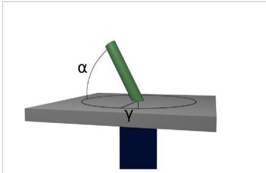
Figura 3.15 Montura Acimutal.
