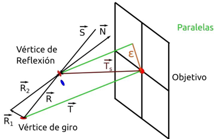
Figura 5.5 Cálculo básico de bisectriz del Helióstato UNAM-36-A.
