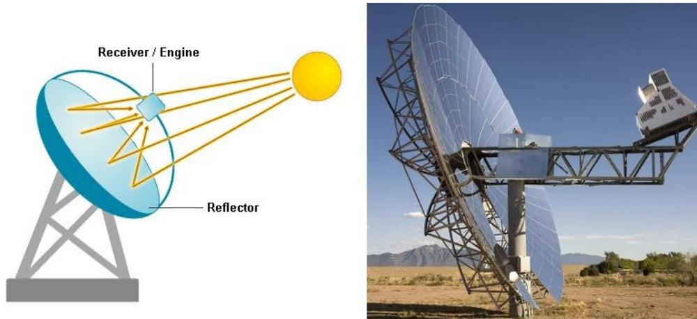
Figura 2.9 Disco Parabólico esquema y planta en operación.
