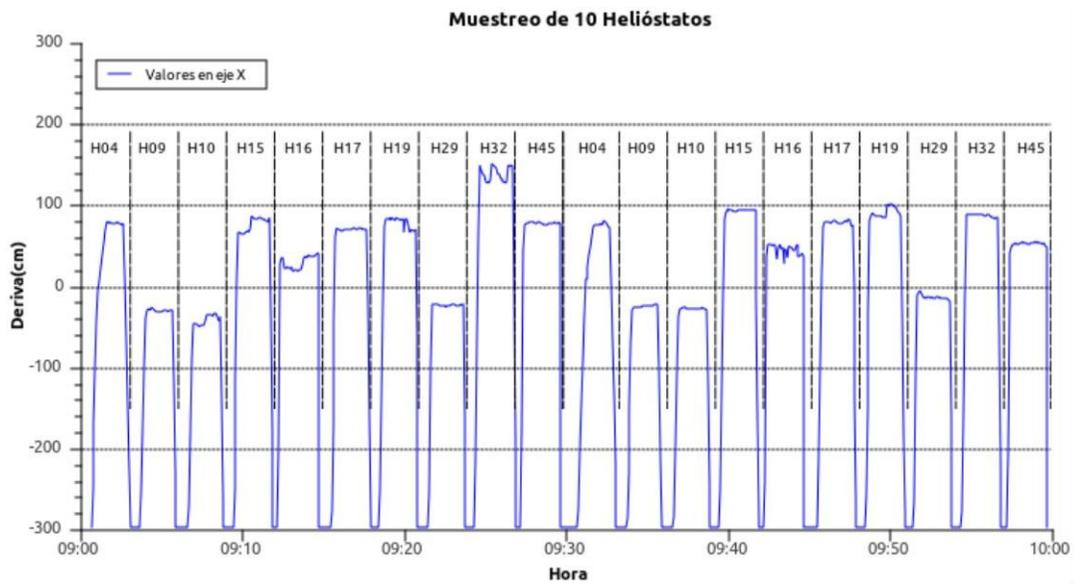
Figura 6.16 Eje X para el centroide de 10 heliéstatos.
