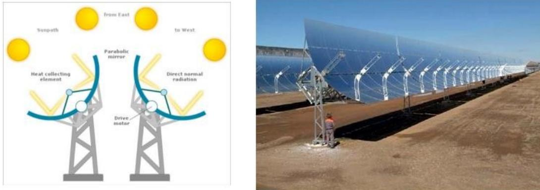
Figura 2.7 Cilindro Parabólico esquema y planta en operación.
