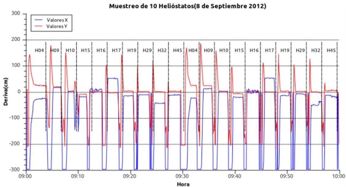
Figura 6.18 Valores X, Y corrección de deriva.
