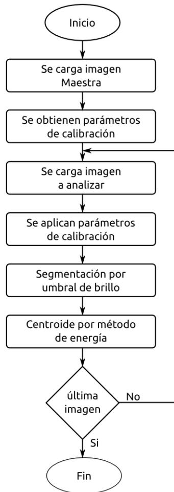
Figura 5.16 Diagrama de flujo procesamiento de imagen.
