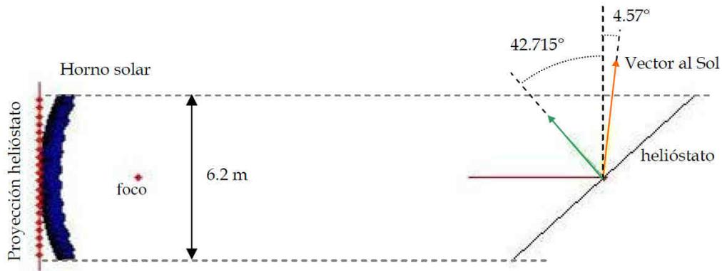
Fig. 3.1. Esquema de la proyección del helióstato sobre el concentrador del horno en el solsticio de verano [Riveros, 2008].
