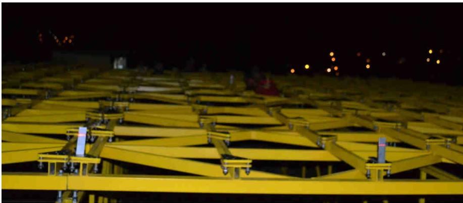
Fig. 4.11. Proyección del plano proveniente del láser sobre las escuadras en las platinas a alinear.
