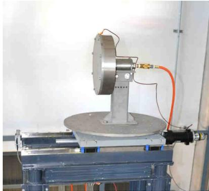
Fig. 5.1. Blanco receptor de placa plana para la captura y procesamiento de imágenes.
