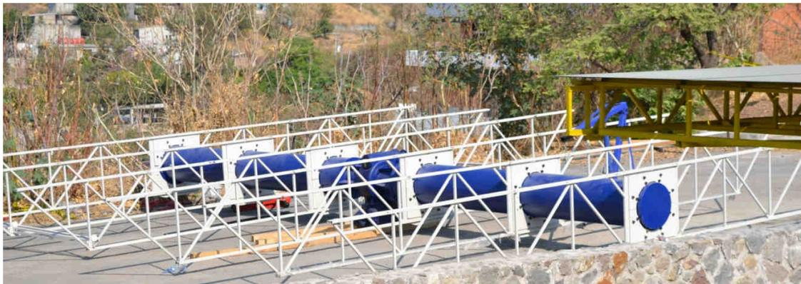
**Fig. 4.5.** Heliostato sin ensamblaje de las facetas.
