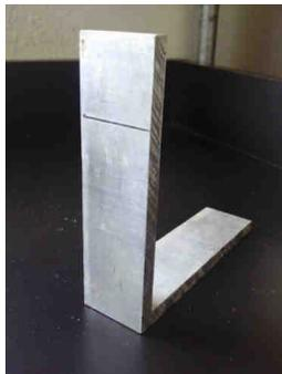
Fig. 4.1. Escuadra utilizada en la alineación.
