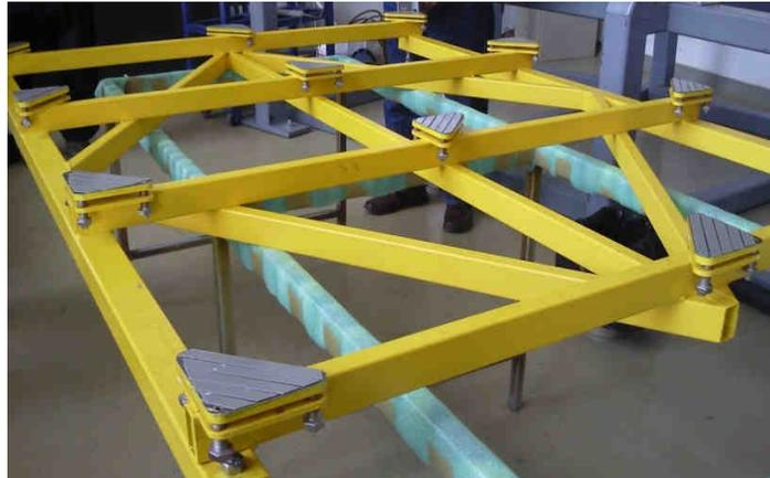
**Fig. 4.13.** Platinas cubiertas con cinta adhesiva tipo "doble cara" para el pegado del espejo.
