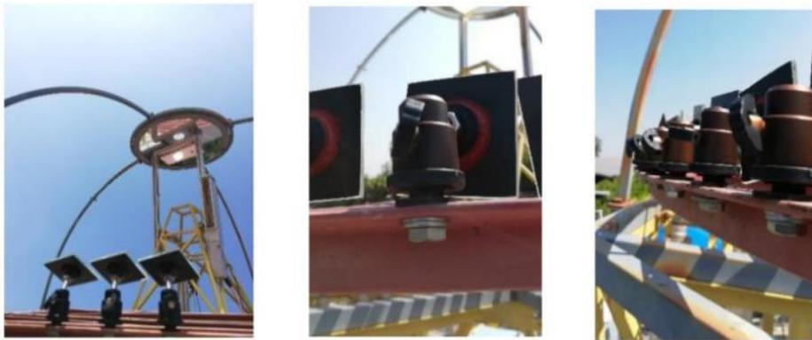
*Figura 4. Montaje del primer elemento óptico (ensamblaje de espejos con adhesivos en la unión de tuerca y sujeción con el espejo)*
