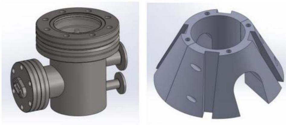
Figura 30. Cámara porta muestras y carcasa guía cónica.
