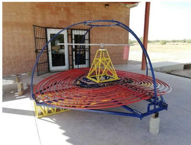
Figura 29. Sistema tipo Fresnel de no imagen para la caracterización de celdas solares de alta eficiencia.
