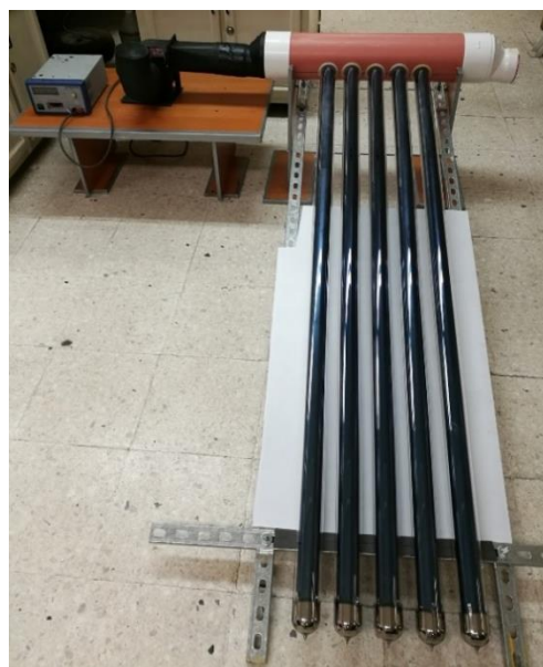
Figura 19. Configuración Experimental del Colector Solar.
