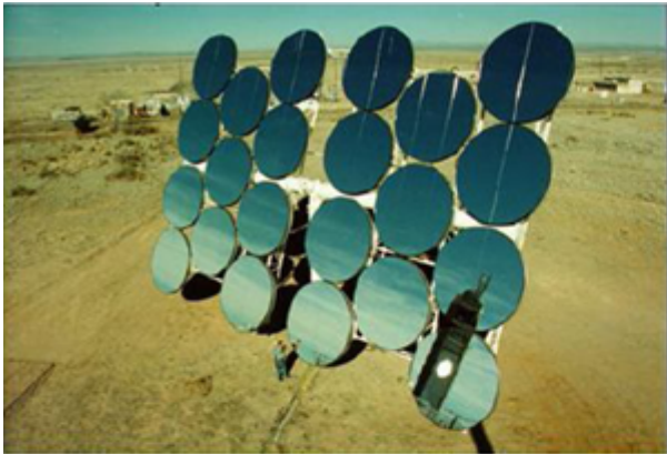
a) Helióstato de espejos circulares cóncavos.
