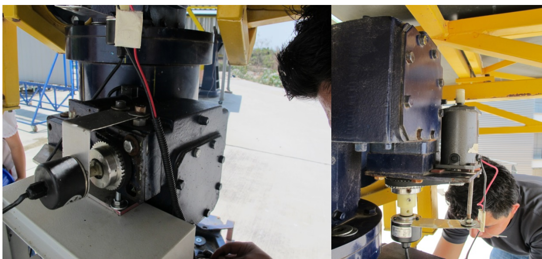
Figura 4. 15 Acoplamiento de motores de CD y Encoders.
