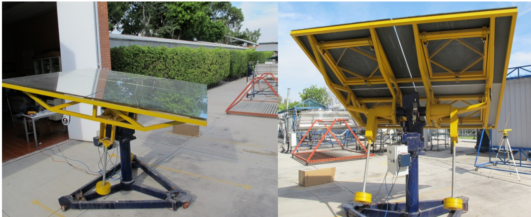
Figura 2.4 Fotografía y esquema de la estructura del Helióstato de 5.6 m 2 para el MSF.
