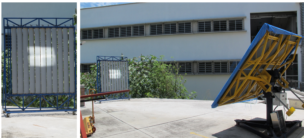
Figura 4. 19 Pruebas preliminares del apuntamiento de la mancha solar del Helióstato.
