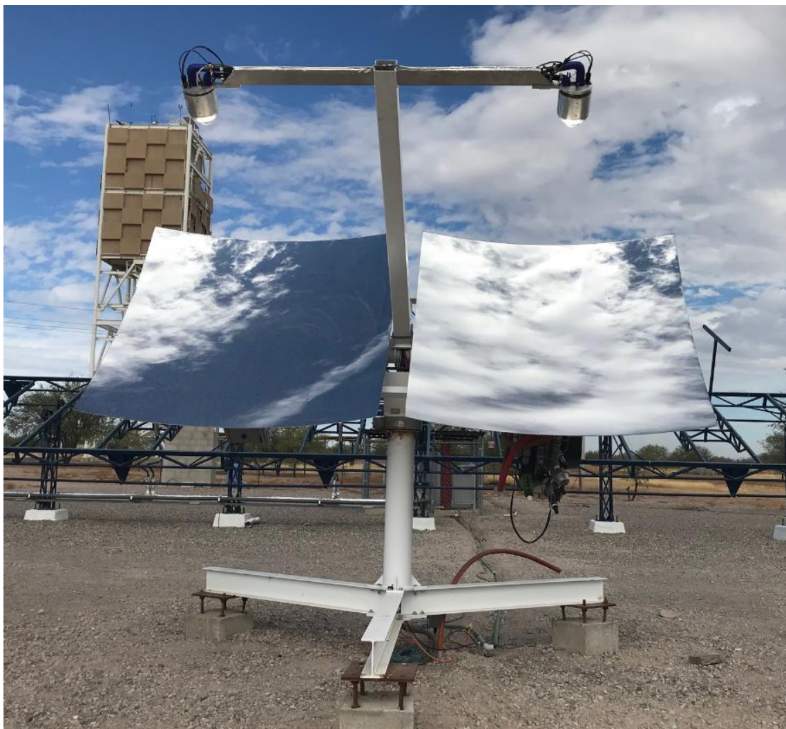
Figura 8. Sistema Fotovoltaico de Alta Concentración, también llamado "2M", localizado en la Plataforma Solar de Hermosillo en Hermosillo, Sonora, México.
