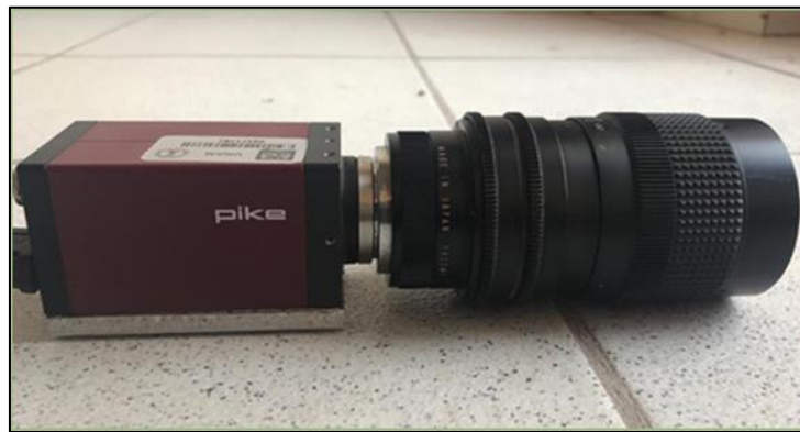
Figura 11. Cámara CCD utilizada fue de 8 bits de la marca Pike Technologies versión 210B.
