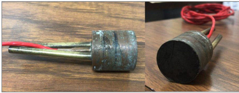
Figura 15. Radiómetro circular, también conocido como Gardon.
