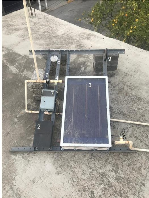
Figura 5.1: Instalación del colector solar y equipo de monitoreo. 1 Gabinete del circuito, 2 Paneles solares para alimentación, 3 Colector solar plano de baja temperatura, 4 Sensor de temperatura de agua a la salida del colector, 5 Sensor de temperatura de agua a la entrada del colector, 6 Caudalímetro, 7 Sensor de irradiancia, 8 Gnomon, 9 Inclinómetro.
