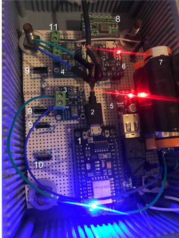
Figura 5.2: Circuito real. 1 nodeMCU, 2 cable USB de emergencia, 3 INA219 para baterías, 4 INA219 para sensor de irradiancia solar, 5 *boost* 5v, 6 Cargador-controlador TP4056, 7 Baterías ION-Litio 18650, 8 *buck* 5v, 9 Puertos de entrada para sensores de temperatura, 10 Puerto de entrada para caudalímetro, 11 Block's de entrada para paneles de alimentación.
