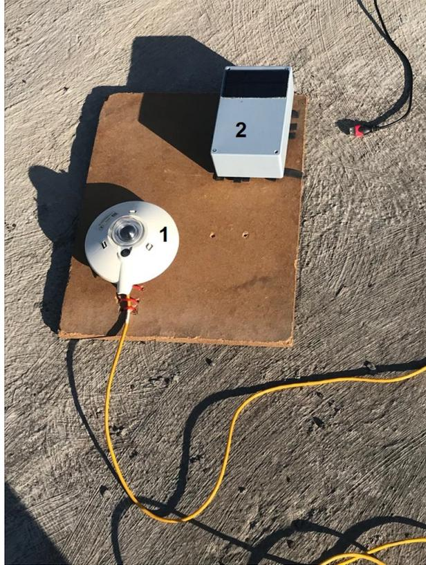
Figura 4.6: Medición horizontal. Orientación sur. 1 Piranómetro, 2 Gabinete del circuito y sensor de radiación.
