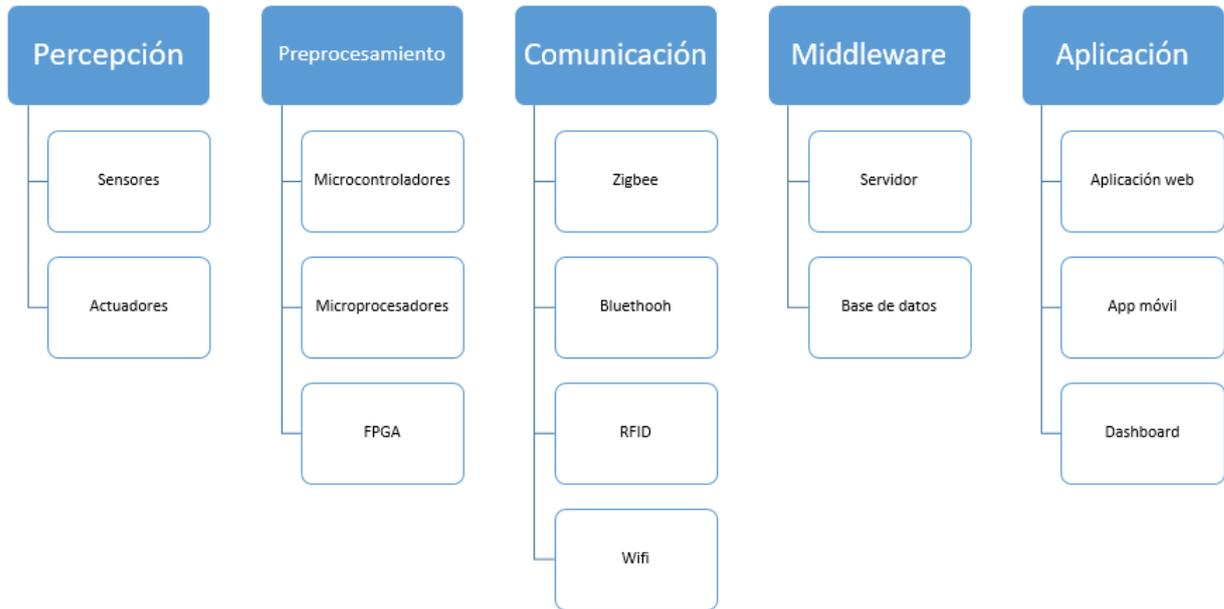
Figura 2.1: Arquitectura básica de un sistema IOT
