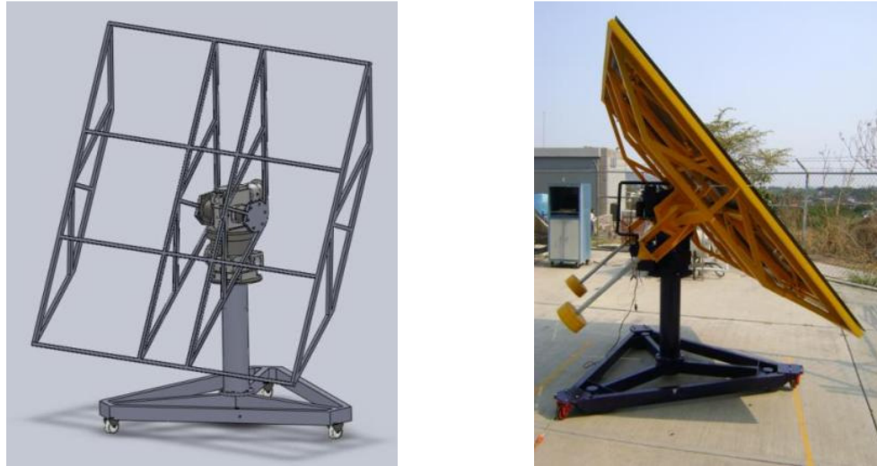
Fig 4: Esquema y fotografía del helióstato de 5.6 \text{ m}^2 del MSF
