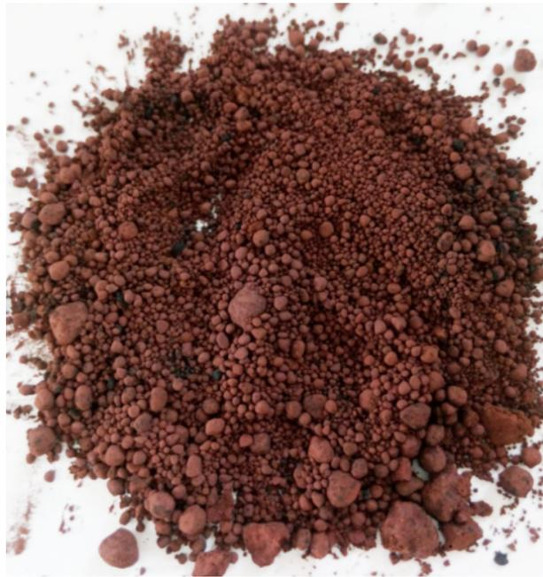
Fig. 31. Producto de ensayo rotativo. Se forman pequeñas esferas y el producto experimenta un cambio cromático hacia el color del  $Mn_3O_4$ .
