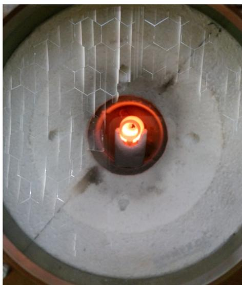
Fig. 10. Reactor a través de la ventana una vez concluido un experimento en modo estático. En el caso que se muestra, el reactivo resultó fundido.
