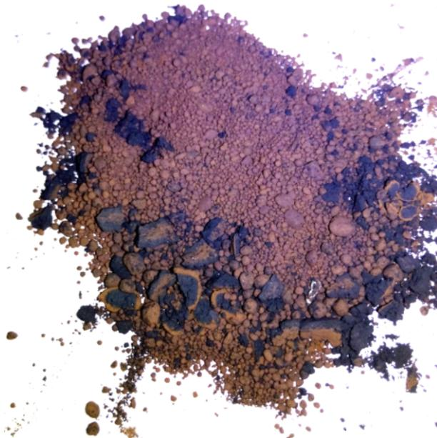
Fig. 47. Producto de ensayo rotativo con aire (ciclado) (ensayo 17). Aparece una fracción marrón-rojiza correspondiente a la parte reducida a  $Mn_3O_4$ .
