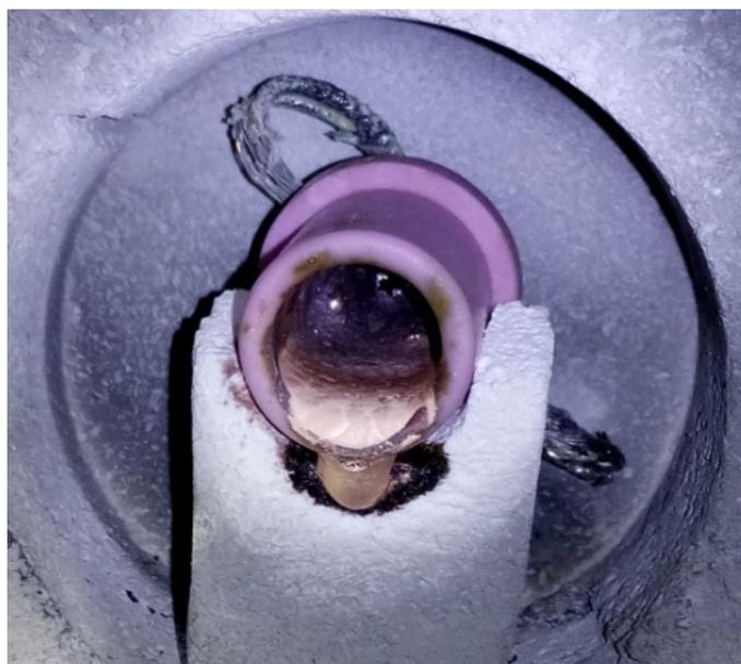
Fig. 19. Producto de ensayo estático en el que se calienta hasta conseguir la máxima liberación de oxígeno posible. El producto resulta fundido.
