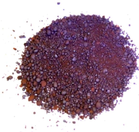
Fig. 20. Producto de ensayo rotativo. Se forman pequeñas bolas y el producto experimenta un cambio cromático hacia el color del  $\text{Cu}_2\text{O}$ .
