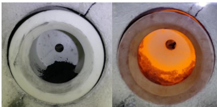
Fig. 11. Cámara de reacción cargada en modo rotativo antes y después del tratamiento térmico.
