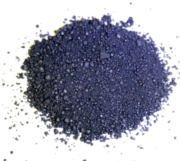
Fig. 41. Producto de ensayo rotativo con aire (ciclado). Se forman pequeñas bolas y el producto presenta un color próximo al del  $\text{CuO}$  (negro) con algunas tonalidades rojizas a causa de la presencia de  $\text{Cu}_2\text{O}$ .
