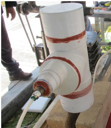
**Fig 2. Sistema de filtrado de gases de salida del reactor**
