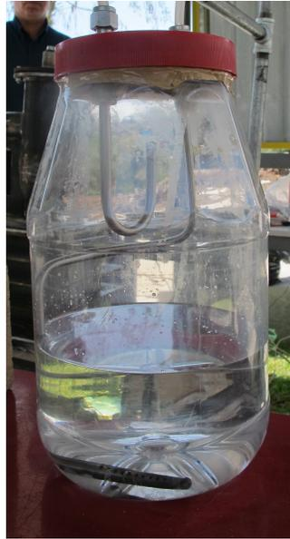
**Fig 1. Trampa de agua para los gases de salida**
