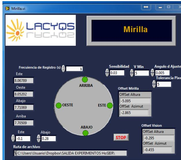
Es importante verificar que el mínimo de los voltajes se encuentre por encima de 5V, en caso que estos valores se encuentran por debajo, se disminuye el umbral del voltaje mínimo para que este comience a hacer los ajustes. Por otra parte, se puede incrementar el ángulo de ajuste para que la operación de corrección sea más rápida. Ya que se encuentren equilibrados los voltajes de los cuatro sensores se puede reducir el ángulo de ajuste a los valores iniciales.
