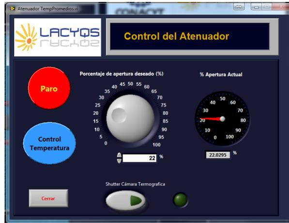
Por otra parte, se tiene el control de apertura del shutter de la cámara termografía, la cual activa el giro del shutter hasta que este desbloquea el lente de la cámara. En cualquier momento se puede interrumpir el giro del shutter de la cámara y dejar expuesta la cámara para que se realice su funcionamiento de manera independiente a la operación del control SCADA.
