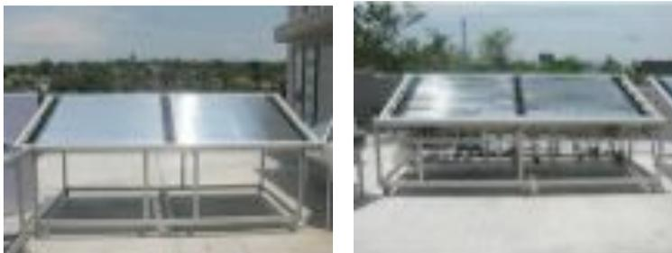
Fig. 22. Captadores solares para Fotocatálisis Homogénea por medio de procesos foto-Fenton. (Izq.) Comprados, (Der.) Fabricados en el CIE.
