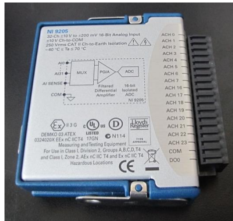
Fig. 5.15 Módulo 9205 para señales de voltaje.
