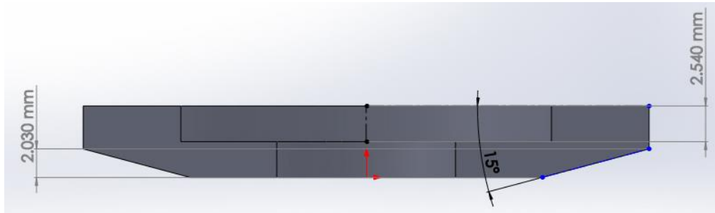
Fig. 3.24 Vista de sección de la brida KF 25.
