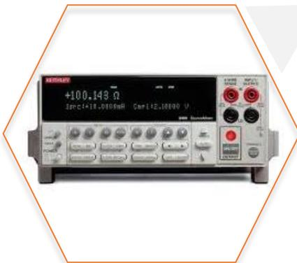
Se midió la corriente generada por las celdas mediante un multímetro digital Keithley, con el cual también se suministró el voltaje. La temperatura del cátodo fue medida con ayuda de un termopar tipo K.
