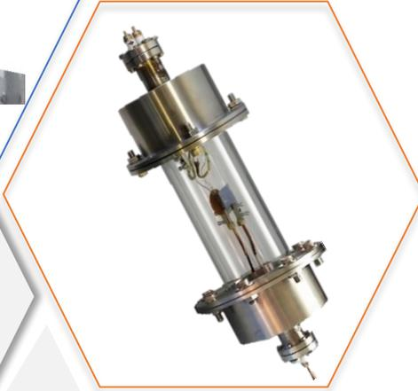
Se introdujeron las celdas al generador PETE, cada una por separado, y se generó vacío dentro de la cámara por medio de una bomba mecánica, alcanzando un vacío de  $10^{-3}$  Torr.
