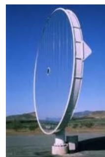
Fig. 1.13c. Helióstato de membrana
