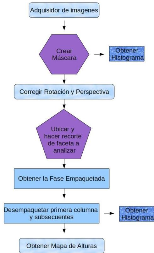
Fig. 3.10. Diagrama de flujo para el análisis de deflectometría.
