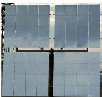
Fig. 1.13a. Helióstato con separación
