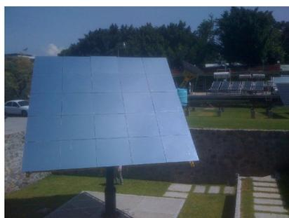
Fig. 1.13b. Helióstato sin separación
