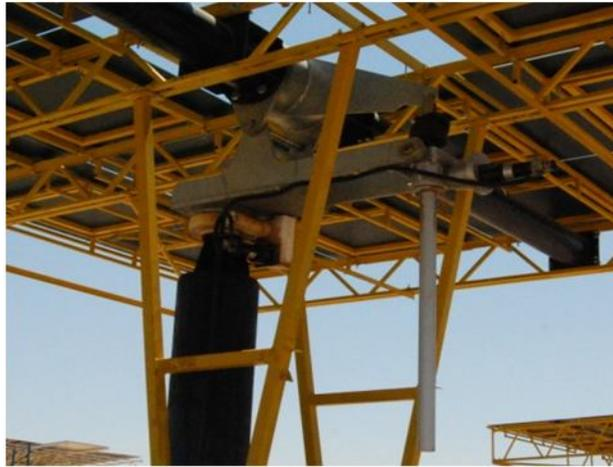
Figura 4.6. Conjunto Mecánico y ejes de giro
