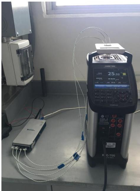
*Figura 4.7. Arreglo experimental de calorimetría dT-History.*
