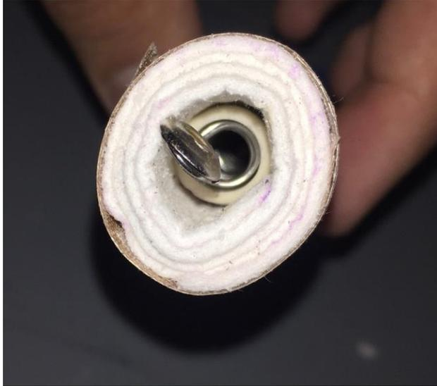
*Figura 4.9. Envolvente aislante de papel de alúmina en la muestra de tubo cerámico.*
