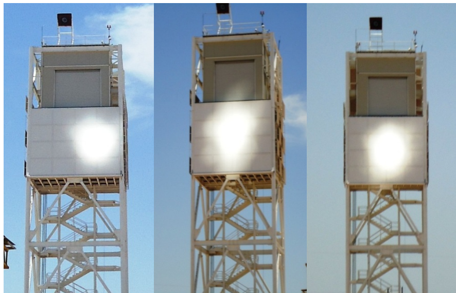
Figura 4.45:(a) 15 facetas canteadas y las demás cubiertas, (b) todas las facetas descubiertas incluyendo las 17 no canteadas, (c) todas las facetas canteadas (CETOC, 2013).
