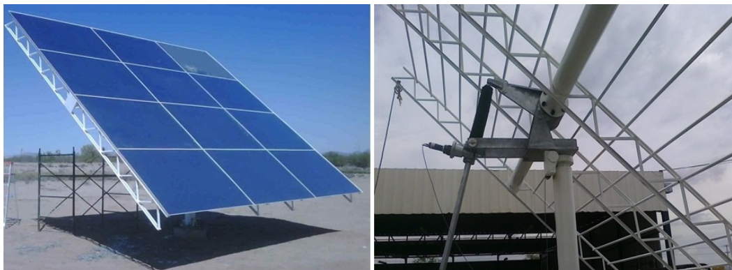
Figura 2.17: Helióstato UNISON-TX-H36 (izquierda) y transmisiones de movimiento (derecha) (CEToC, 2008).
