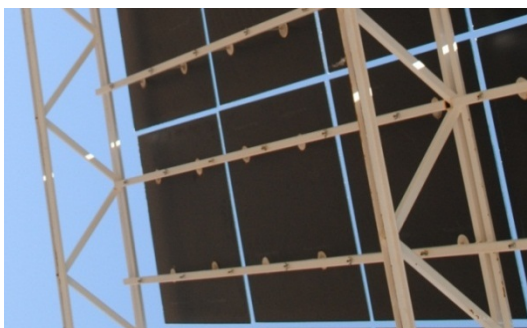
Figura 2.19: Sistema de sujeción y canteo de espejo del heliostato UNISON-TX-H36B (CEToC, 2010).
