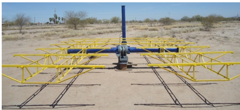
Figura A.1. 1: Ensamble estructural del helióstato (CETOC, 2013)
