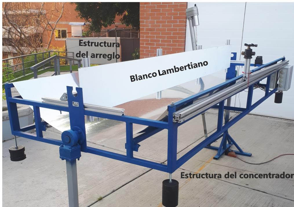
**Figura 2.15:** Disposición del blanco Lambertiano en el sistema de concentración
