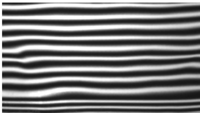
**Figura 3.5:** Faceta de colector solar plano bajo el análisis de reflexión de luz estructurada [34]
