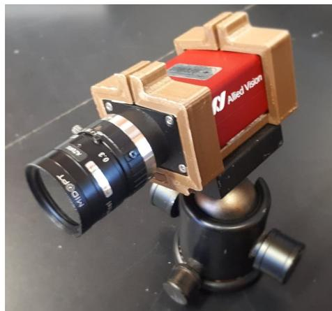
**Figura 2.21:** Soporte fabricado para la cámara CCD G-125B
