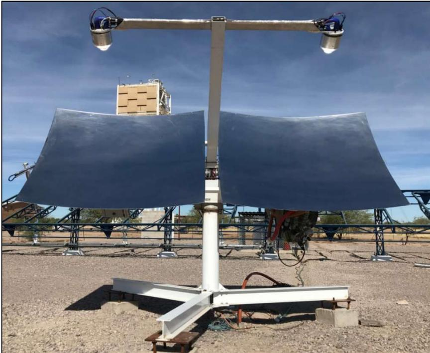
**Figura 4.** Concentrador PV de disco parabólico con celdas triple unión y óptica Kohler.
