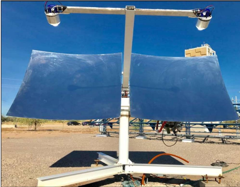
**Figura 36.** Sombramiento realizado por la estructura de soporte y los PCUs sobre el área reflectora.
