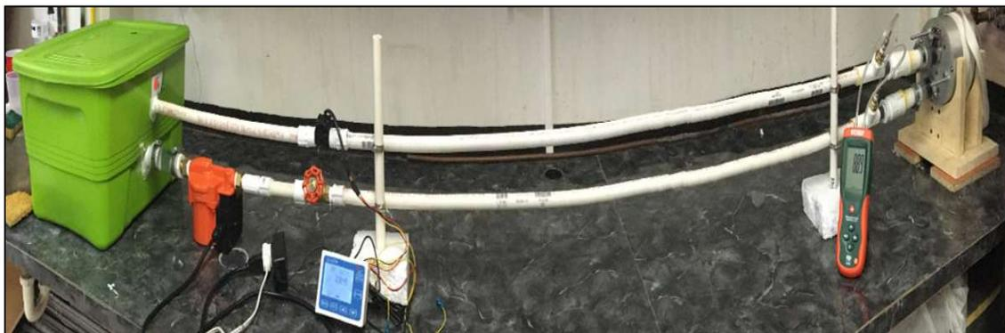
**Figura 18.** Sistema hidráulico de pruebas para la evaluación de la caída de presión dentro de una unidad de conversión de potencia.
