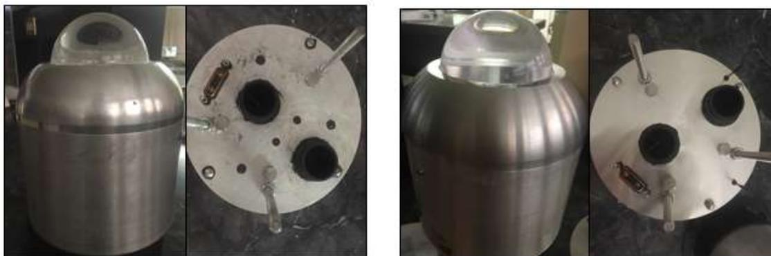
**Figura 17.** Unidad de potencia sin entrada de gas nitrógeno (izquierda) y unidad de potencia con entrada de gas nitrógeno (derecha)
