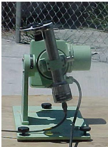
Figura 4.2. Pirheliómetro con el equipo de seguimiento del sol
