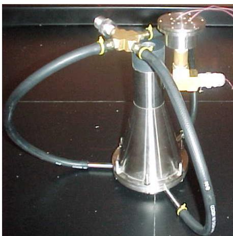
Figura 4.3. Calorímetro armado e instrumentado listo para hacer experimentación.
