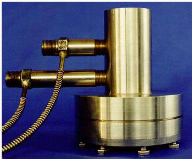
Figura 1.5. Fotografía del calorímetro de placa plana.
