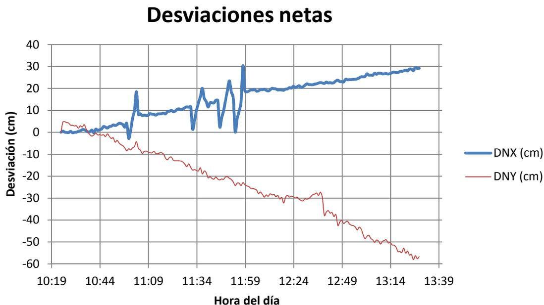
Figura 4.10 Desviaciones netas de la proyección frontal del heliostato durante el periodo de tiempo de operación del horno solar.
