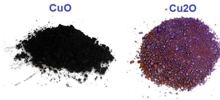
Fig. 5.13. La figura muestra la comparativa visual del reactivo inicial  $CuO$  y el producto final  $Cu_2O$ .
