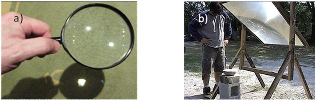
Figura 1.1. Sistemas de concentración solar a través de sistemas translucidos. a) Lente convencional. b) Lente tipo Fresnel.
