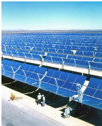
*Figura 1.6. Imagen de un sistema de concentración solar tipo canal parabólico.*
