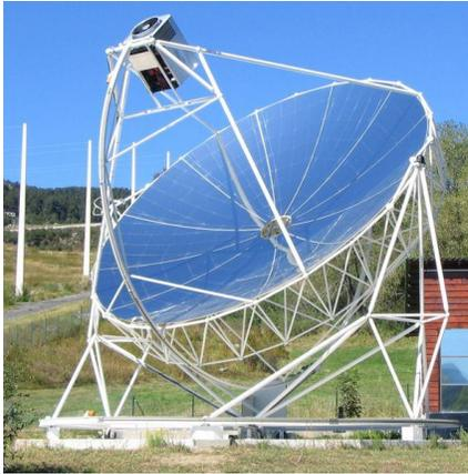
Figura 1.4. Fotografía de un concentrador dish Stirling (EURODISH, PSA).
