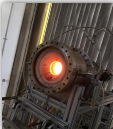
Figura 2.8: Reactor rotativo para la reducción de óxidos metálicos. Campaña experimental realizada en el HoSIER – UNAM.
