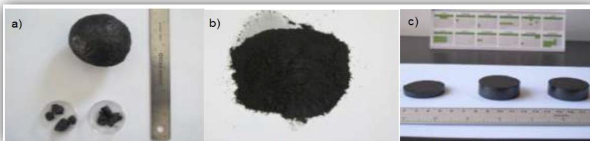
Figura 2.21: Muestra de coque de petróleo. a) Esferoides con diámetros entre 15 y 45mm como se obtienen de la refinería. b) Coque pulverizado con molino de discos vibratorios con tamaños de partículas de 106  $\mu\text{m}$ . c) Pastillas de 40 mm de diámetro y 16 mm de altura.
