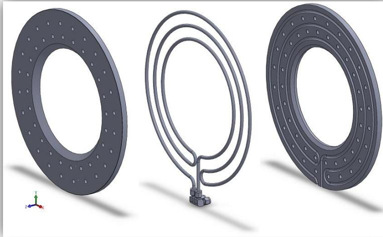
**Figura 5.7: Elementos del ensamble de brida y tubing de cobre.**
