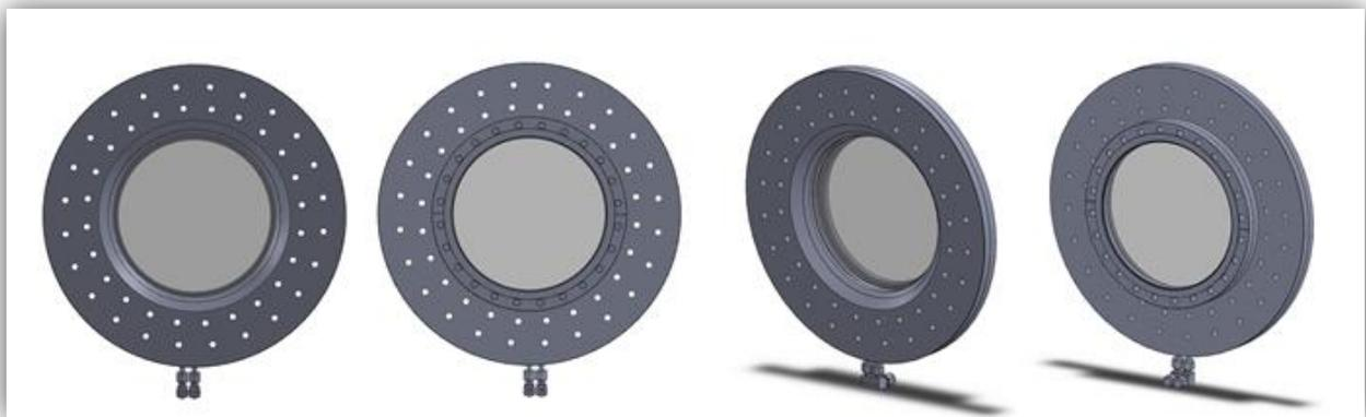
Figura 3.5: Arreglo de brida refrigerante con ventada de cuarzo. De izquierda a derecha, vista frontal, vista posterior y dos vistas isométricas.
