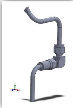
Figura 5.12: Inyector de gas Argón de acero inoxidable.
