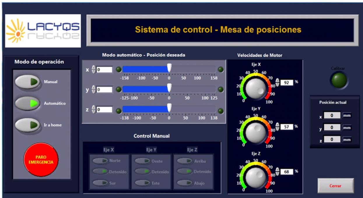
*Figura 4.2. Interfaz gráfica del sistema de control de las posiciones en la mesa de experimentación.*
