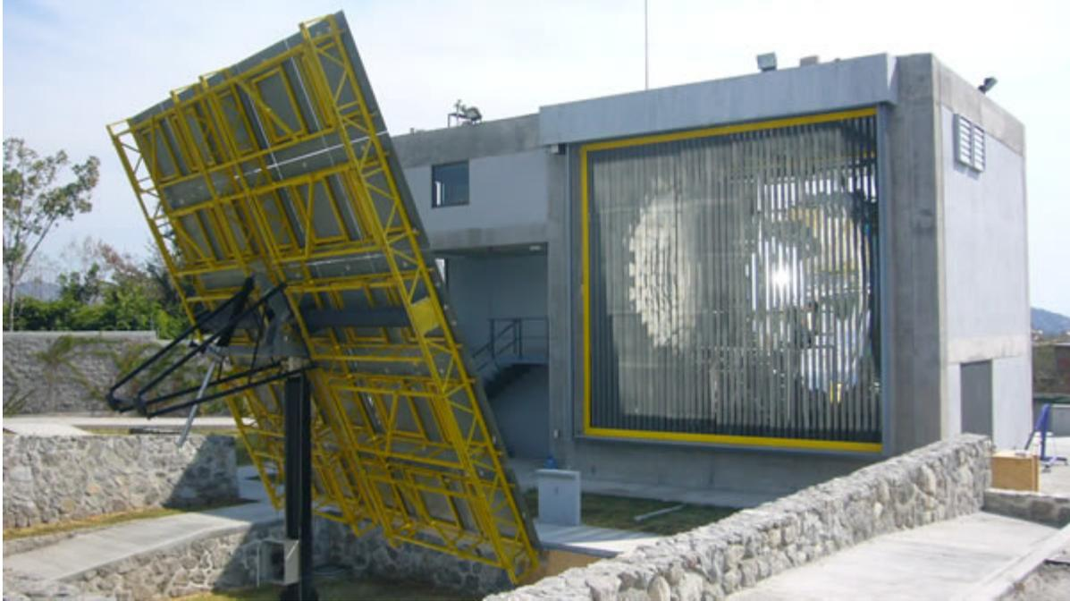
*Figura 2.3. Horno Solar de Altos Flujos Radiativos (HoSIER).*
