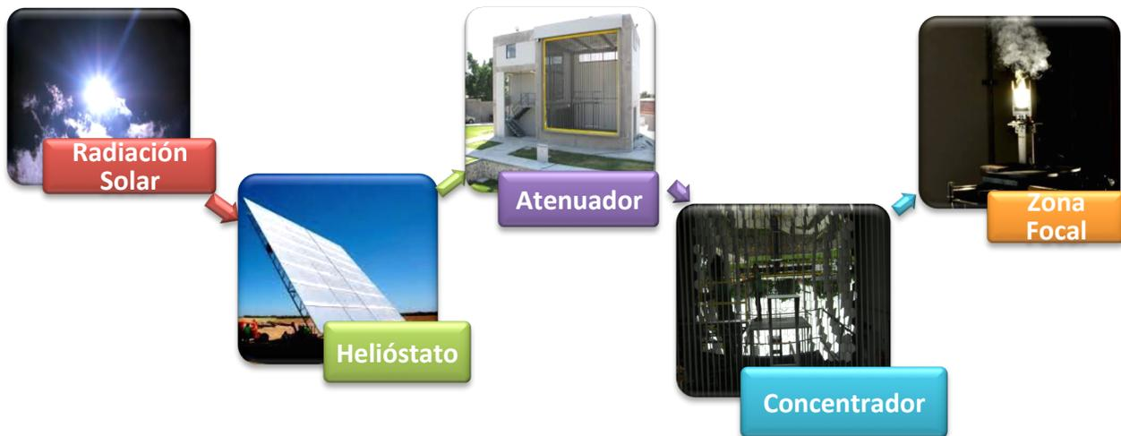
*Figura 2.1. Diagrama a bloques de un Horno solar de altos flujos radiativos.*
