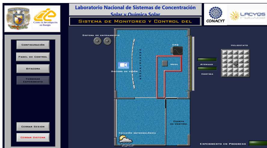
Fig. 3.5 Pantalla principal del sistema de control SCADA del HSAFR, CIE-UNAM
