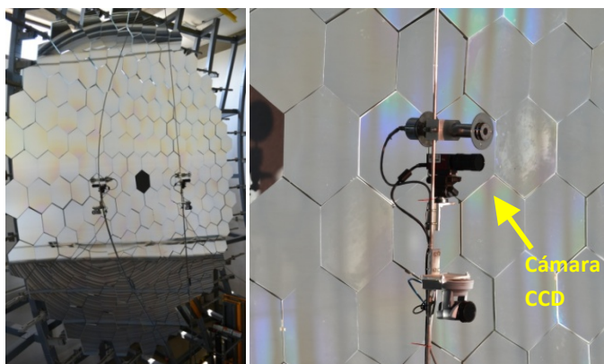
Fig. 3.4 Cámara CCD montada al centro de la óptica para captura de imágenes
