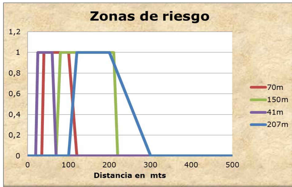
Figura 4.2. Zona de riesgo al ver directamente a la fuente de a los helióstatos.
