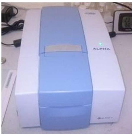
Figura 3-6. Espectrofotómetro IR marca Bruker modelo Alpha (Universidad Autónoma de Sinaloa).
