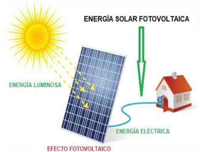
Figura 2-2. Sistema de obtención de energía solar fotovoltaica.
