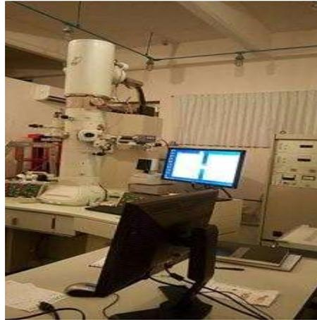
Figura 3-9. Microscopio electrónico de transmisión (Universidad de Sonora).
