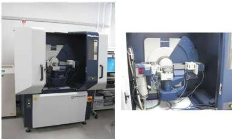
Figura 3-8. Difractómetro de rayos-X Rigaku ULTIMA IV (IER-UNAM).
