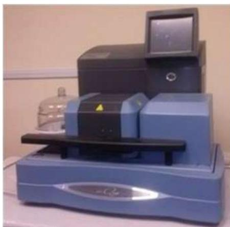
Figura 3-7. Equipo de análisis térmico TA Instruments SDT Q600 (Universidad Autónoma de Sinaloa).
