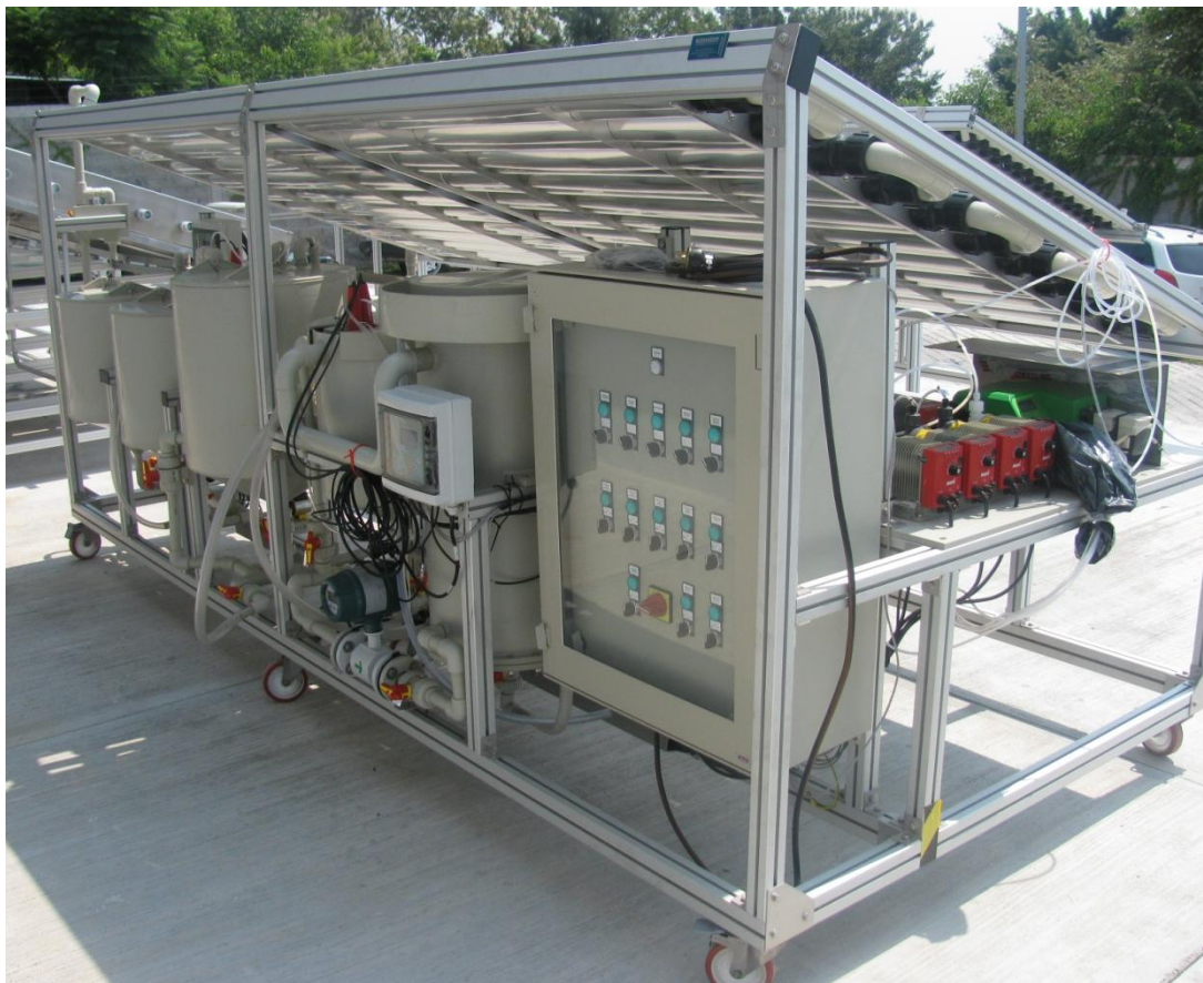
Figura 4.17. Planta piloto de proceso foto-Fenton acoplado a un reactor biológico, Ecosystem.
