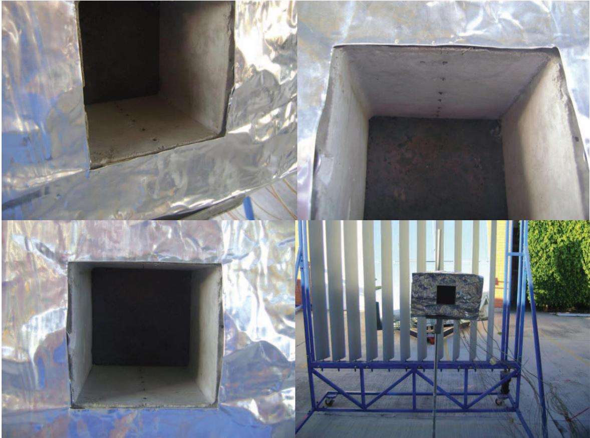
Figura 5.15. Instrumentación de la cavidad con termopares.
