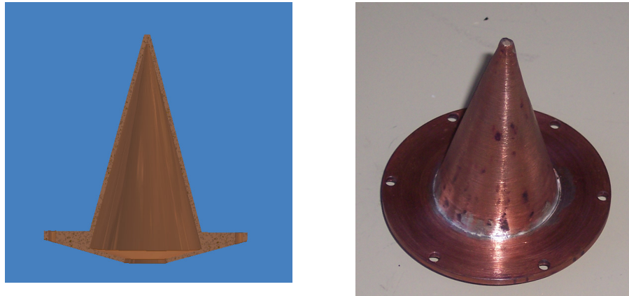
Figura 4.3. Corte trasversal y fotografía del cono receptor.
