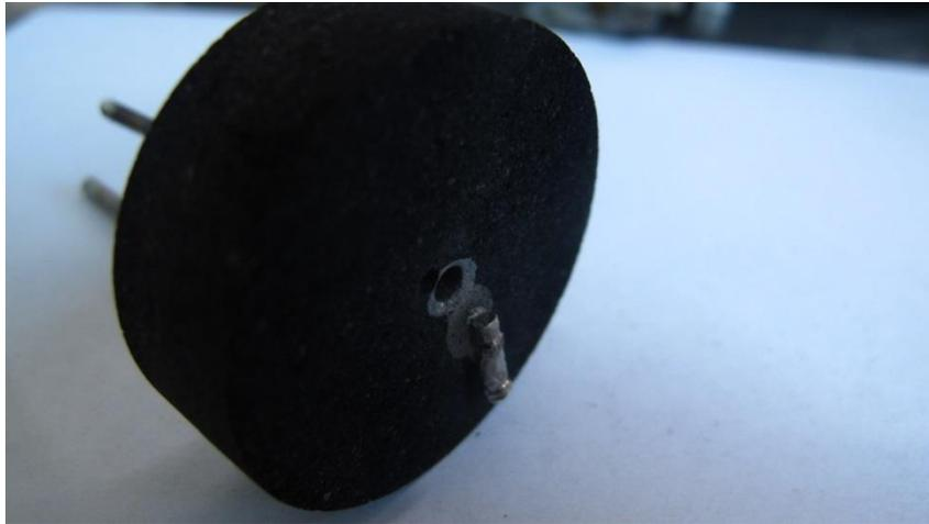
*Figura 4.26. Imagen del tungsteno fundido en el grafito.*
