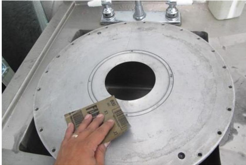
*Figura 4.15. Imagen de la cubierta del calorímetro a la que se le está puliendo con lijas finas.*
