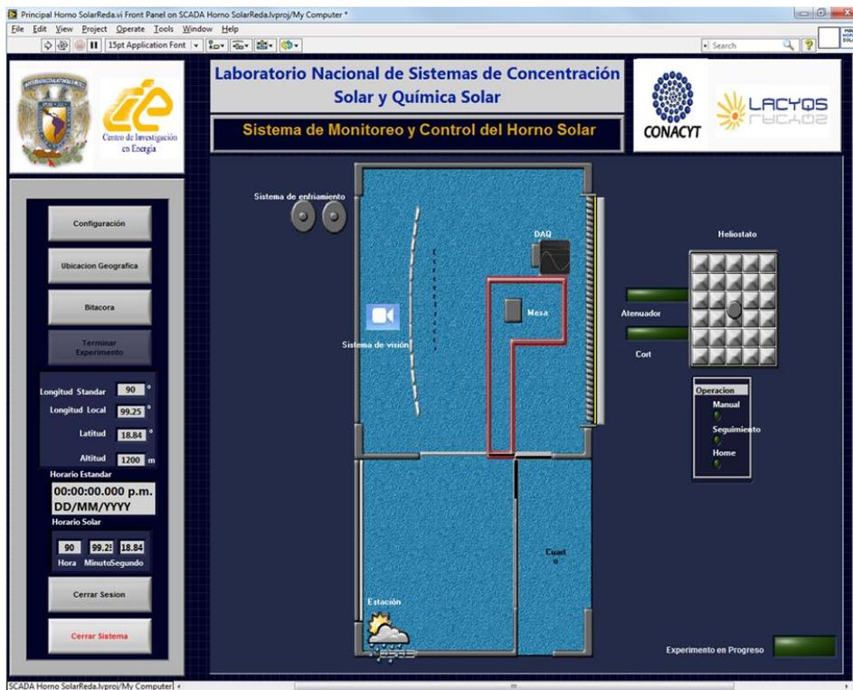
Figura 2.11. Pantalla principal del sistema de control del HoSIER.
