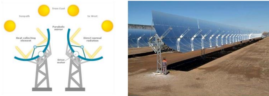
Figura 2.7 Cilindro Parabólico esquema y planta en operación.
